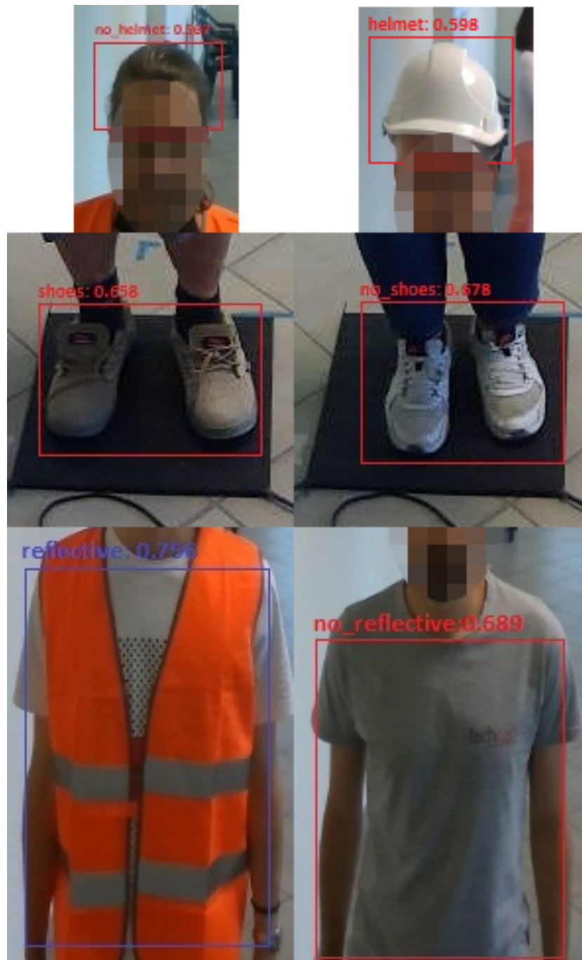
Figura 4.8: Risultati dei primi test delle reti neurali adoperando modelli allenati al riconoscimento di un singolo dispositivo o alla sua assenza
