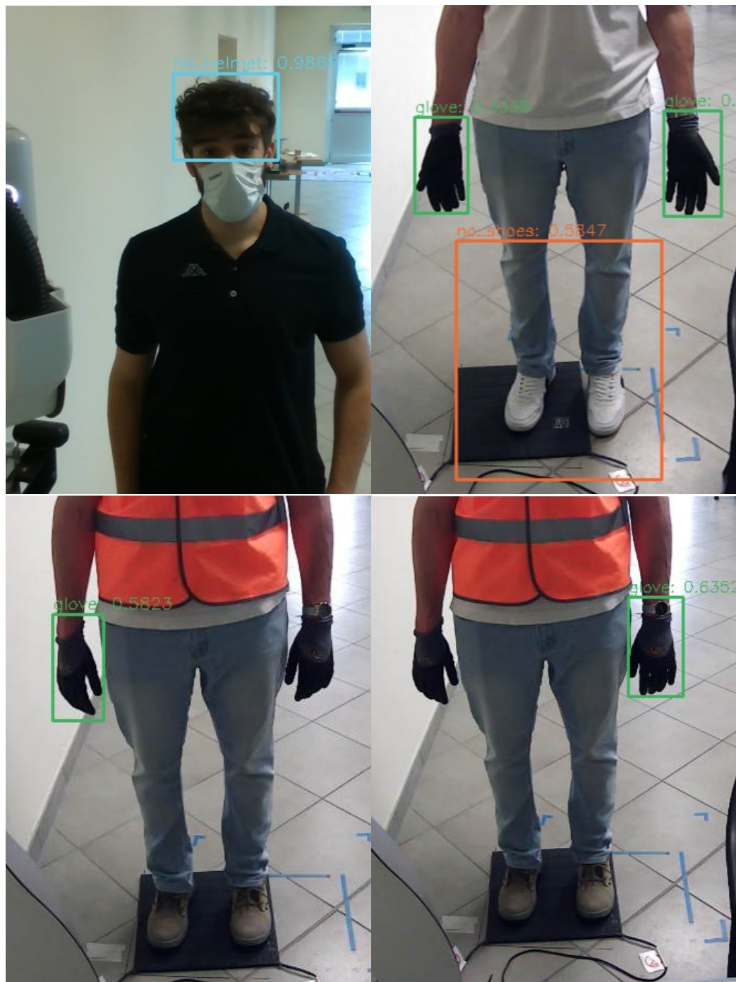
Figura 4.7: Prima fase in cui il modello aveva il compito di riconoscere ogni dispositivo, abbandonata per gli scarsi risultati ottenuti.
